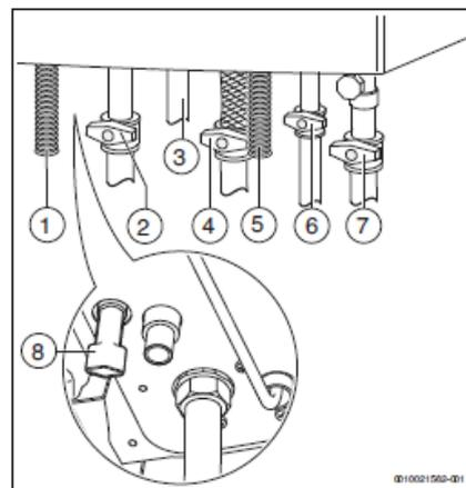
Lassen sie den Hahn geöffnet bis auf der digitalen Druckanzeige 1.5 bar angezeigt werden.
