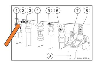
Lassen sie den Hahn geöffnet bis auf der Druckanzeige 1.5 bar angezeigt werden.
