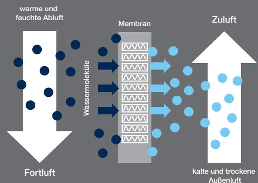
Hohe Wärme- und Feuchterückgewinnung mit dem Logavent HRV176 E mit Enthalpie-Wärmetauscher.
