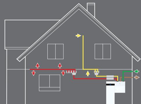
Die Funktionsweise des Systemlüftungsgeräts
