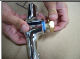
5 - dévisser l'écrou en laiton
