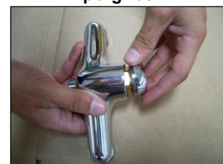
4 - dévisser le couvercle chromé bague-écrou
