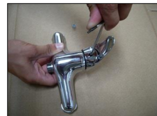
2 - desserrer la vis de la poignée
