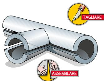
**3** Assemblare le due parti, ottenendo così la diramazione a "T". Tagliare il manufatto in senso longitudinale al fine di consentire il montaggio
