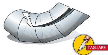
**3** Praticare un taglio longitudinale, in modo da poter montare il manufatto sul tubo curvo e poi incollare
