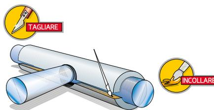
**2** Tagliare la guaina in senso longitudinale e montarla sulla tubazione. Spalmare con la colla i bordi tagliati e incollare
