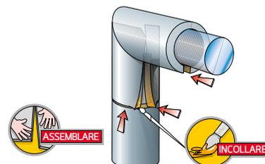
4 Rivestire il gomito con il pezzo ottenuto, incollare i bordi del taglio premendoli per farli ben aderire e raccordare con altre guaine rettilinee dello stesso diametro
