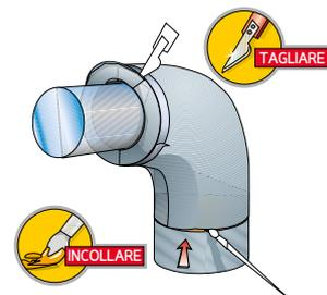
7 Rifilare ad angolo retto le due estremità, utilizzando come guida un nastro metallico, in modo da far combaciare i tratti di isolante adiacenti
