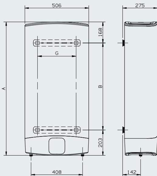
Installation horizontal nur möglich, wenn Anschlussrohre links und Kaltwassereingang unten
